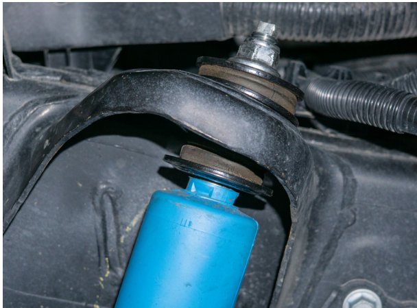
Fig. 16: Remove stem top nut.
