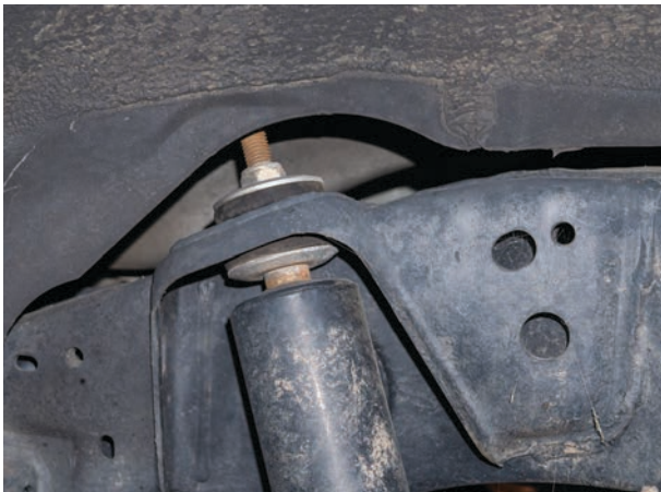
Fig. 20: Remove stem top nut.
