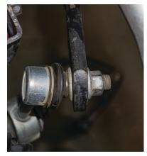
Fig. 14: Tie rod end link.
