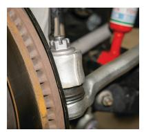
Fig. 1: Tie rod end link.
